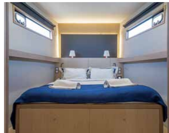
La cabine avant doit composer avec le V étroit de l'étrave, d'où la surélévation importante du lit double.
