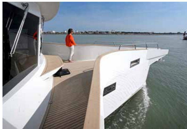
La partie avant présente un profil d'une grande originalité, avec cette étrave pincée prolongée par une delphinrière.
