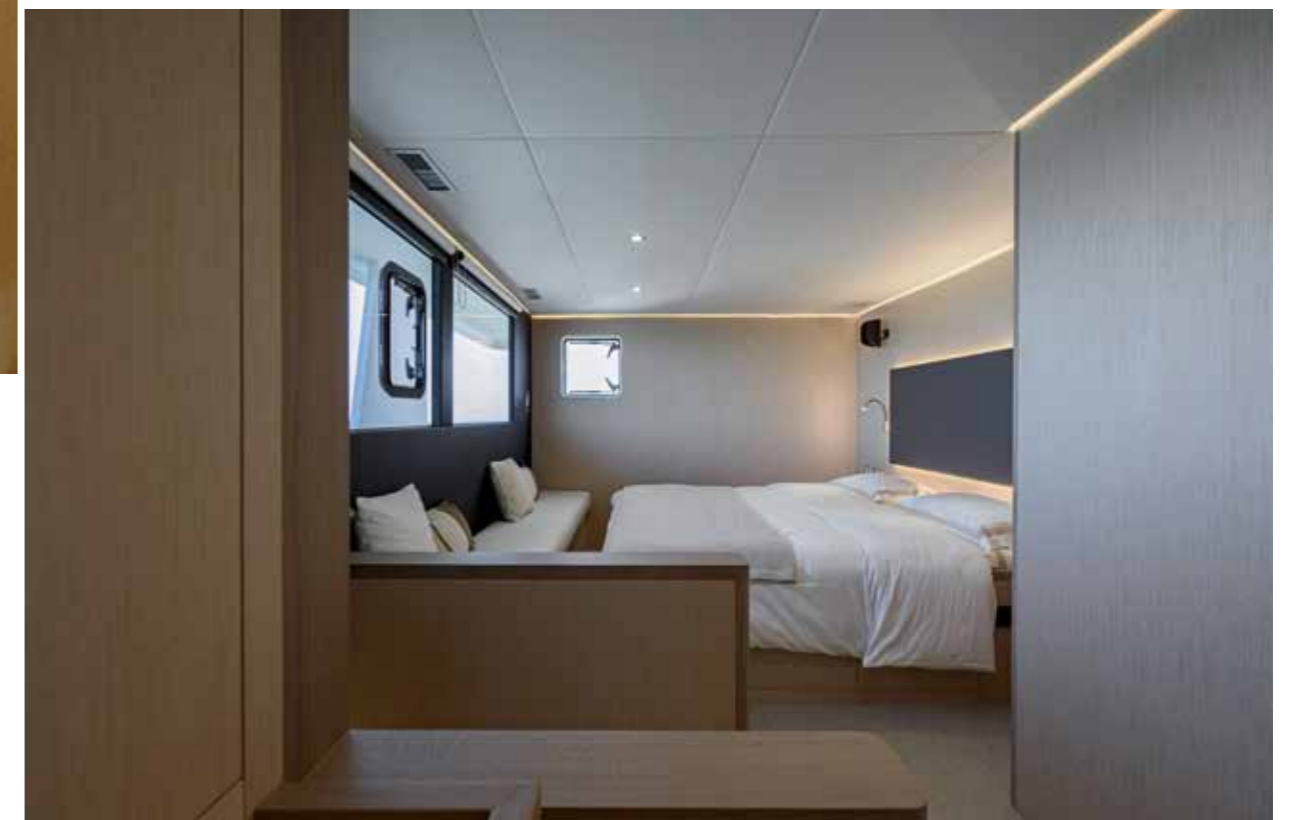
Le chantier reprend l'idée phare du Leen 56, développée aussi sur ses voiliers trimarans: une cabine propriétaire implantée sur le pont principal, au contact du grand salon.
