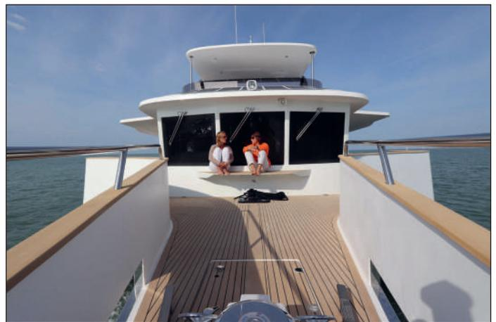
Tout le pontage profite d'une protection exceptionnelle avec de très hauts pavois. Les passavants présentent même un dévers de 5° de façon à assurer un écoulement rapide de l'eau qui pourrait être embarquée. La face avant de la nacelle est inversée pour conserver une bonne visibilité par tout temps.
