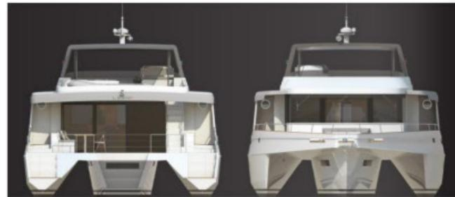
Ces vues de face montrent le profil des coques. Les surfaces développées des carénages ne nécessitent pas de moulé.
